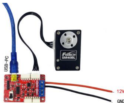
SMS 系列舵机接法示意图
